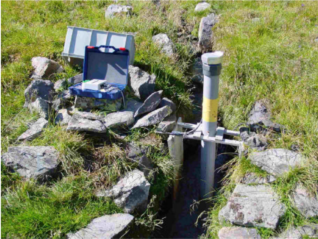
Abbildung 7: Automatische Registrier- und Datensamlereinheit für Druck-, Leitfähigkeits- und Temperatursonden
